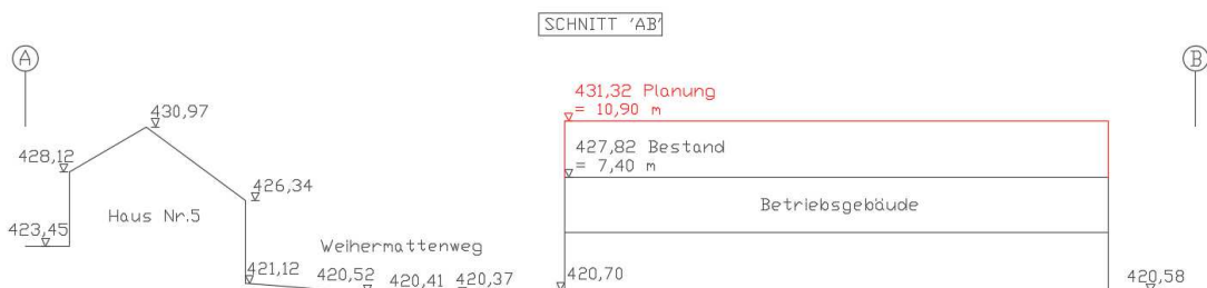
Schemaschnitt Betriebsgebäude – Wohngebäude Haus-Nr. 5 (ohne Maßstab), fsp
